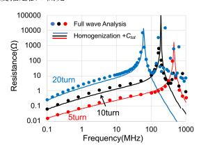
おいても 5 分以上は要してしまう。これよFig. 2 Analysis results of plane coil by proposed method b、本手法を用いることにより、高周波特性(Dots: full wave analysis, Lines: Homogenization  $+C_{tot}$ )[2] を高速かつ高精度に表現できる解析法を確立できた。
