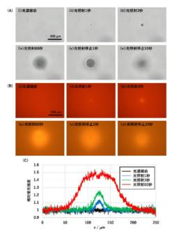
図 4. HEWL(50 mg/mL)/BSA(50 mg/mL)混合溶液における光濃縮誘起 LLPS 微小液滴形成。透過像(A)と蛍光像(B): 光照射前(i) 光照射中(ii, iii, iv) 光照射後(v, vi) (C) 蛍光像のラインプロファイル。
