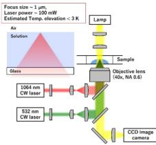
図1. 構築した光濃縮誘起 LLPS 観測のための透過像・蛍光像測定装置。
