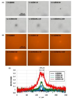
図 3. HEWL 溶液(100 mg/mL)における光濃縮誘起 LLPS 微小液滴形成。透過像(A)と蛍光像(B): 光照射前(i) 光照射中(ii, iii, iv) 光照射後(v, vi)(C)蛍光像のラインプロファイル。
