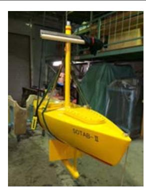
器を載せるための排水量の観点から、セーリングヨットの船型を用い、油検知センサーを含む各種機器の搭載を考慮して、キールの大きさと取り付け位置、帆で浮流重油を追従させるのに必要なブレーキ板、舵、ジブセールの大きさを、動的復原性と操縦性の観点からシミュレーションを行うことにより設計した。また色々な条件に対応できる浮流重油を自動追跡する制御系の設計を行った。
