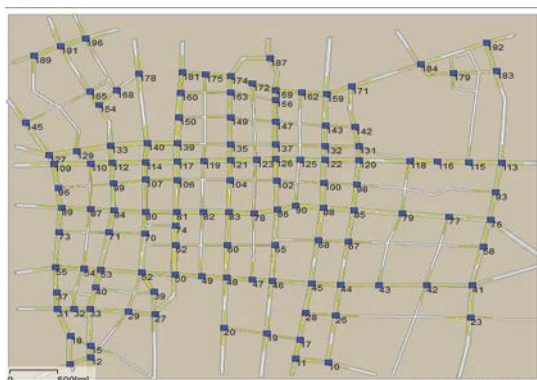
図 4. 121 個の路側機の配置
