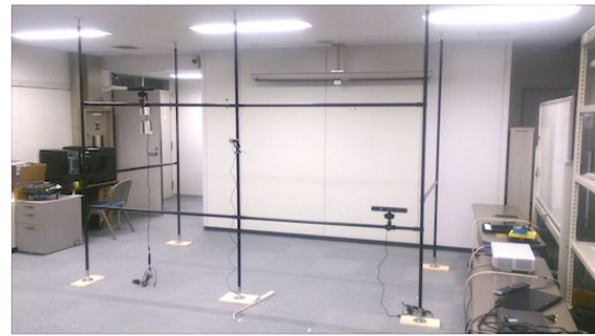
図6 3D撮影装置のカメラ・レンジセンサ群
