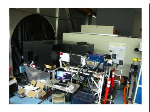
すばる望遠鏡に搭載した SCExAO システムの外観。望遠鏡本体は左の壁の向こうにあり、そこから補償光学 AO188 を経て、中央の SCExAO システムに光が入る構造である。青く小さなボックスは SCExAO で使用する近赤外線カメラ HiCIAO である。
