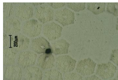
図1 線材断面(黒点部が断線の起点)
