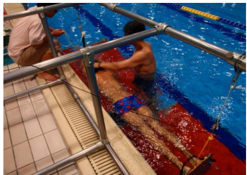
写真 2 浮力・浮心重心間距離の測定
