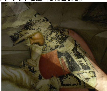
写真8 甲冑を身につけた騎士：錫ペストにより黒く変色している（斜光線照射）
