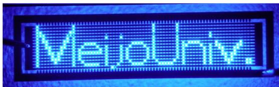
図7 トンネル接合によるマトリクス駆動  $14 \times 72$  ドットマイクロディスプレイ
