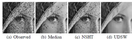
図 3 画像 lena に対する画僧修復の例 (a) 観測画像 (b) メディアンフィルタの結果 (c) 冗長ハール変換と ISTA による修復結果 (d) 混成指向性重複直交変換と ISTA による修復結果
