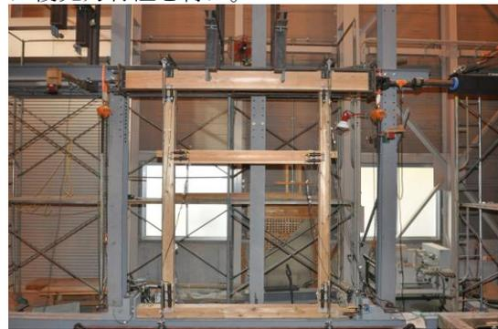
図 1 尻はさみ継ぎ(弱軸)試験体
