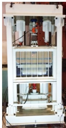
写真1 模型杭載荷試験装置
