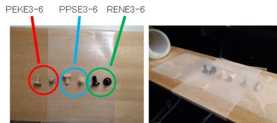
図 3：固定用ねじの X 線吸収の評価
