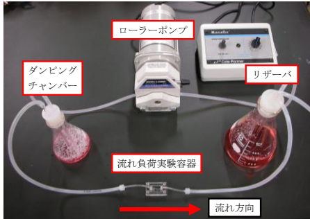
図 3.1 流れ負荷実験装置
