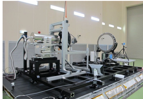
図2:(上)本研究における実験セットアップ。右側奥に口径30 cm小型平面鏡と回転ステージが設置されており、左側手前に干渉計が光学調整ステージ上に設置されている。回転ステージは望遠鏡光軸を中心に回転し、各回転位置で望遠鏡の透過波面の測定を行う。(下)口径90 cm大型平面鏡による、望遠鏡開口全面の測定。
