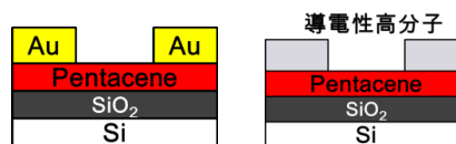
図5 作製したOFETのデバイス構造(左:デバイスA、右:デバイスB)
