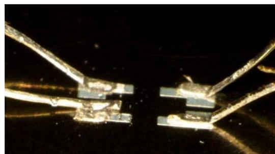
図4 電極膜にアルミ線を超音波ボンディングした例
