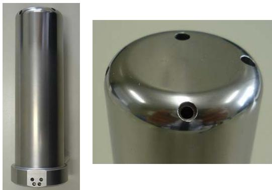
図 11 製作したカウンタパンチ (センサ挿入前)
