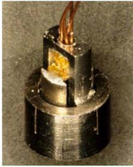
図5 リード線配線後の摩擦センサ
