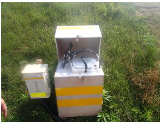
図 9 梯川堤防内に設置した静電容量式水分計
