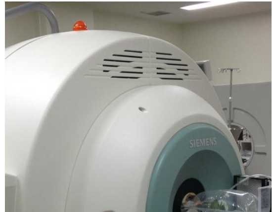
図2 使用した分子イメージング装置のシーメンス製小動物用 PET の Inveon。小動物用ベッド部分に測定対象となったダイズ植物をセットし、地上部全体を封入しガスを供給できるようにしている。地上部全体には LED ライトで光エネルギーを供給している。
