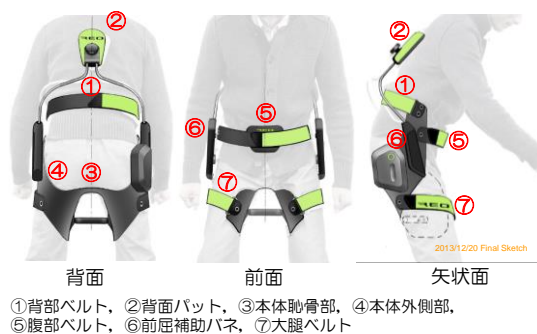
図8 3号機の外観と各種パーツ
