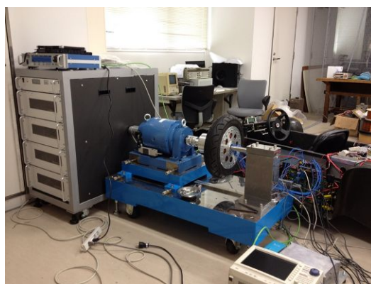
図1 小型 SR モータを用いた実機試験
