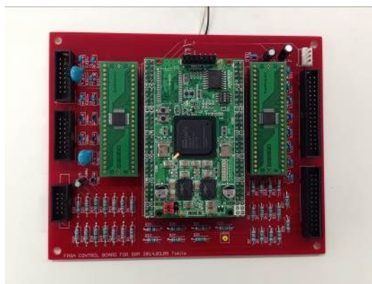
図5 開発したFPGAベースの制御回路
