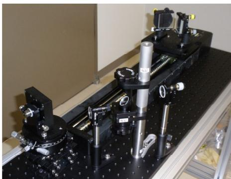
図5：設計・製作した紫外光用パルス圧縮器の写真
