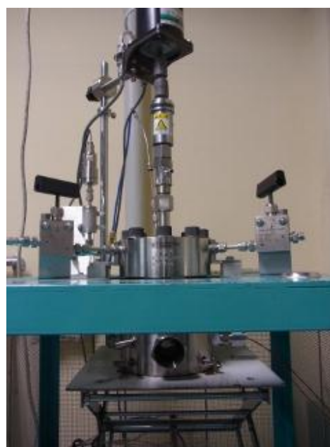
図2 電極窓付き高压容器
