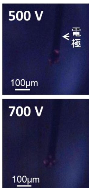
図 3 導電性流体（超臨界 \text{CO}_2 + \text{NaCF}_3\text{CO}_2 + \text{メタノール} ）中、W 電極先端部で発生させた電解プラズマの様子
