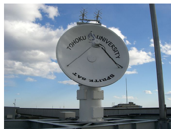
図 4 2285MHz 電波受信アンテナ(データ受信および電波周波数計測用)
