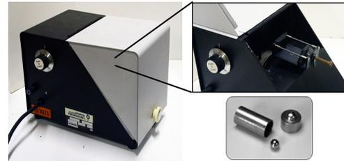
図 1 振動型ボールミルおよび粉砕セル
