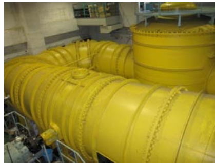
図2 火星の飛行状態を模擬する惑星環境風洞
