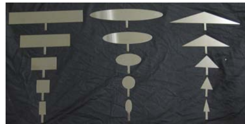
図3 三次元翼模型 (矩形翼、楕円翼、三角翼： AR = 0.5 \sim 6 )
