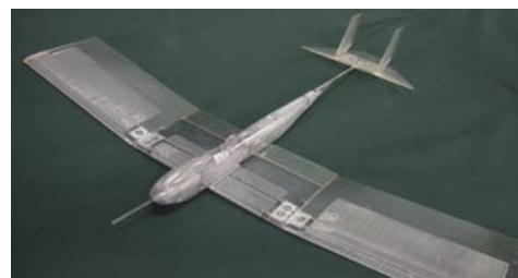
図4 火星飛行機の全機風洞試験模型 なお舵効きの評価については図5に示すような舵面付きの翼型模型を使用した要素試
