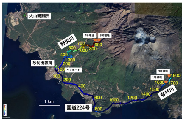
図1. 桜島火山におけるDAS観測。2024年6月3日から7月25日に観測を行った。砂防出張所に光送受信装置(インテロゲータ)を設置。光ファイバーの1系統は野尻川沿いの総延長4.5 kmで、925チャンネルに相当し、2系統は国土224号と有村川沿いの総延長8.7 kmで、1805チャンネルに相当する。サンプリング周波数は500Hz、測定間隔4.8 m、ゲージ長9.6 mである。
