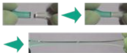
図 5 : PA ゲルの切断面自己修復の様子。
