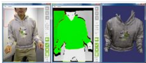
図 15 RGB-D 画像からの衣服部分の切り出し (左: RGB、中: 深度画像、右: メッシュ)
