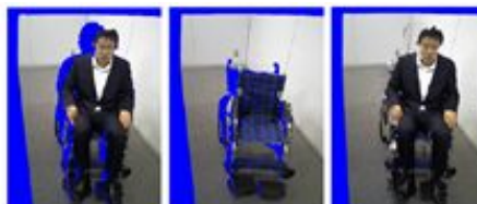
図 19 DR と Inpainting による RGB-D カメラの オクルージョン部分の穴埋め
