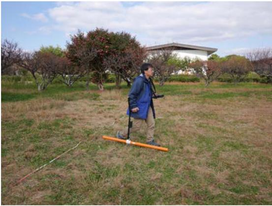
図 6) 三深度電磁探査機の試験
