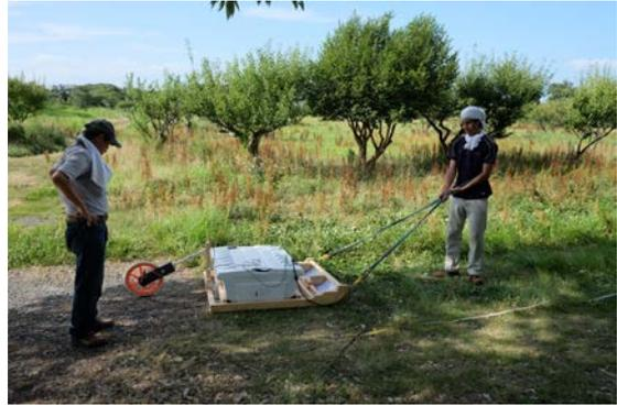
図 3) GPR 用そりの製作と試験
