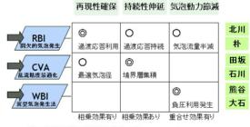
3×3の二次元的なアプローチで抵抗低減性能を改善 (撥水性塗料効果はRBI、マイクロバブル発生技術はWBIに入れている)
