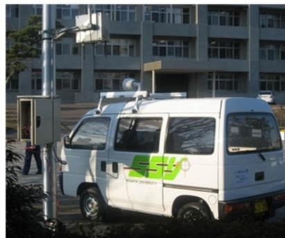
図 3 試作したカメラ、通信機器を搭載した電気自動車
