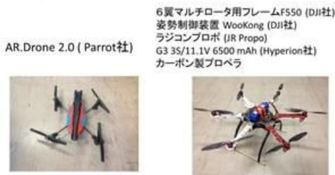
図8 複数回転翼無人飛行機の開発
