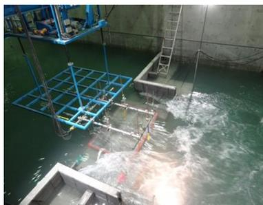
図2 沼田跨線橋の水利模型実験状況
