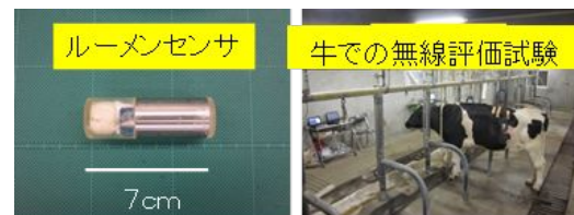
図 1 ルーメンセンサと無線通信性能評価試験
