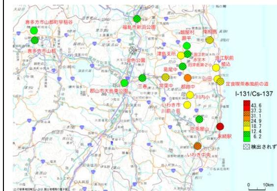
図2. ヨウ素131の濃度とセシウム137の濃度の比。いずれの試料の値も2011年2月15日に半減期補正した。
