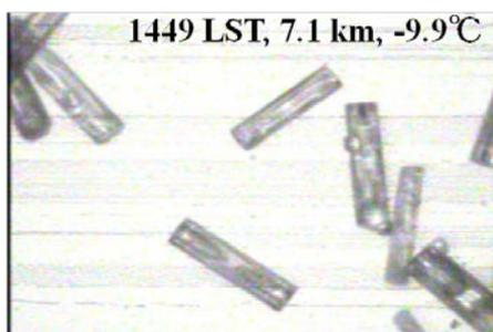
図 7. 2013年6月15日14時30分にアイメリークサイトから放球されたHYVISにより、高度7.1 kmにおいて取得された氷晶粒子（柱状粒子）の画像。画像の横軸は1.2 mm、縦軸は0.9 mmである。
