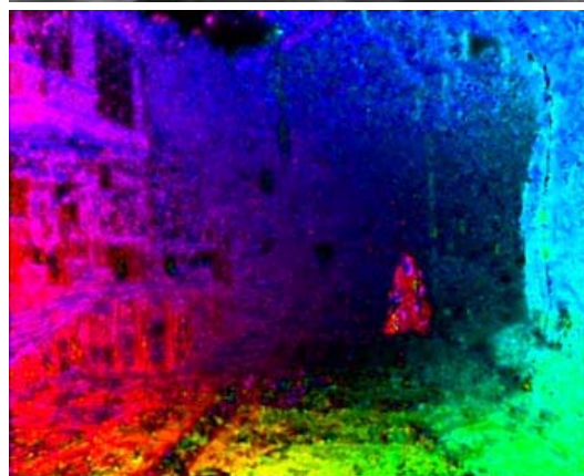
図1 移動する車載カメラからのオプティカルフロー検出結果 (左: 強度画像, 右: 速度分布を方向を色相, 大きさを明度でカラー表示したもの)。周囲の固定物からは撮像系の自己運動による三次元情報が、これらと異なる速度場として、接近する自転車のような運動対象が容易に分離される。
