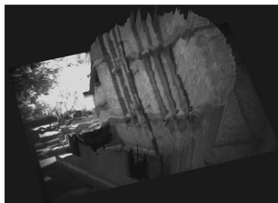
図3 円振動眼ステレオによる立体再構成。建物の外壁や窓枠や背景の樹木が1フレームで再構成されている
