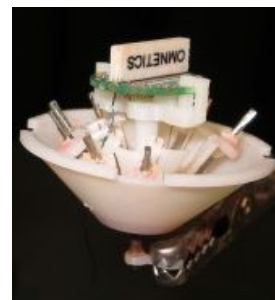
図1. 本研究開発のスタート時に設計した脳活動記録・刺激用装具の3D CADによるデザイン(左)と、3Dプリンタによる出力(右)
