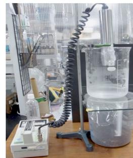
Fig.3 水の線遮蔽実験
