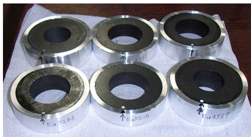
図1. 磁石を構成する超伝導バルク磁石材料
