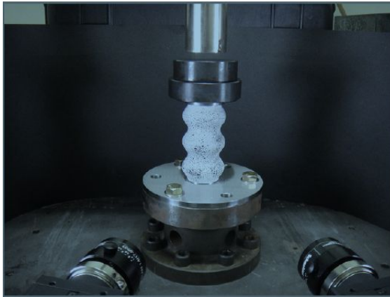
図 7 強制変位による軸圧縮試験: 波形管表面にはランダムパターンが塗布しており DIC により歪を算出する。
