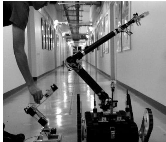
図1: 不整地移動マニピュレータのマスタスレーブ型遠隔操作システム
