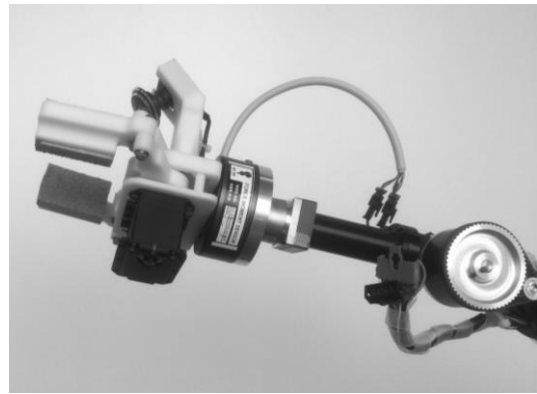
図6：手先に搭載された力覚センサ
