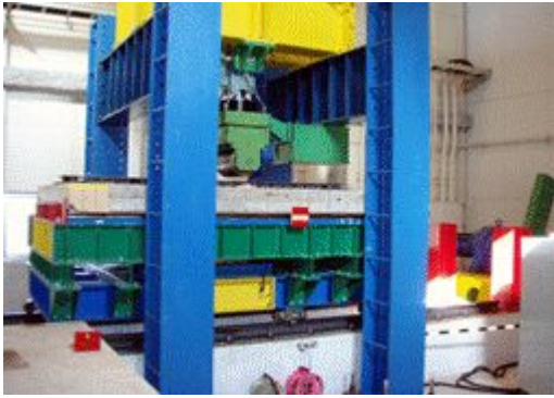
写真-1 輪荷重走行試験機
