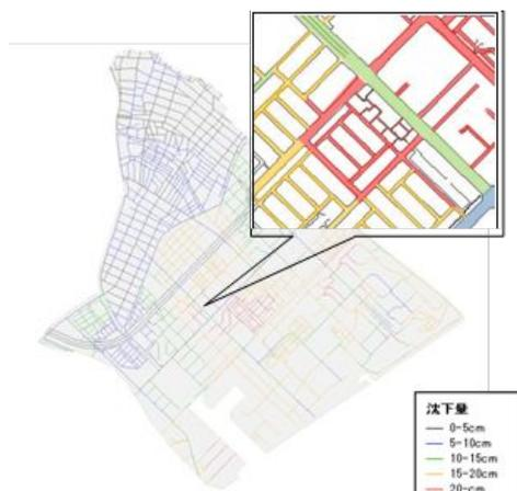
図 13 液状化道路沈下マップ
