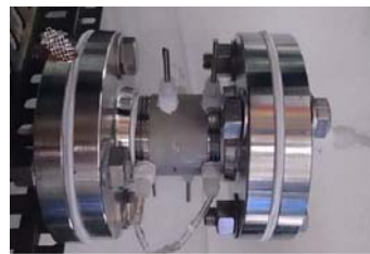
写真1 パイプ内に設置した電解セル
