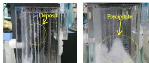
写真 2 リンの除去・回収の様子
