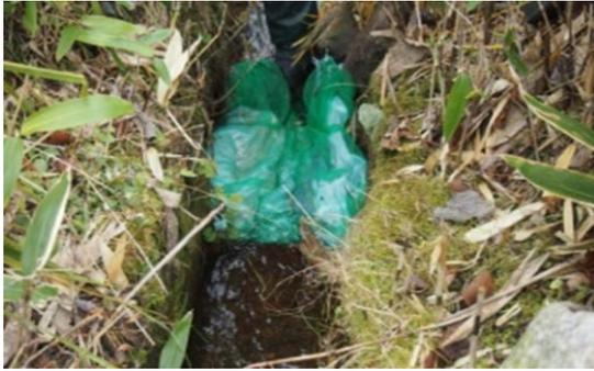
図2 珪藻土の溪流への設置状況
