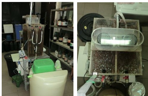
写真1 活性汚泥リアクター (SBRとSB-MBRが並列されており、同一の排水を用いた処理実験を行うことができる)
