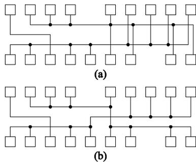
図3: 2本の水平線分を用いることにより, 辺交差数を削減できる例
