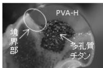
図 1 イヌ大腿骨頭に埋入した人工関節軟骨デバイス
